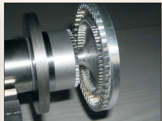
Przekrój oraz wykonana tarcza wirnikowa mikroturbiny promieniowej czterostopniowej
