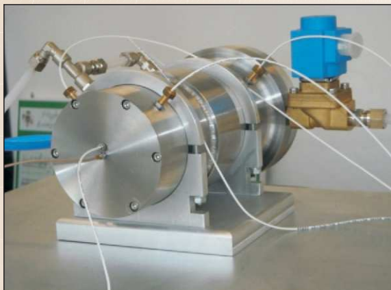
Prototypowe rozwiązania konstrukcyjne mikroturbin (mikroturbina czterostopniowa i jednostopniowa-naddźwiękowa)
