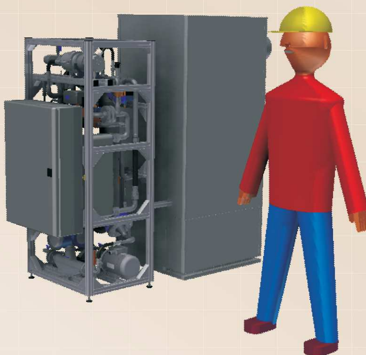
Wygląd zewnętrzny przed-prototypu mikrosiłowni kogeneracyjnej ORC
